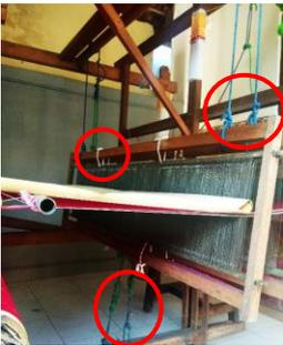
Gambar 10. Tali Tambang yang Terangkai pada ATBM Tampak Samping
